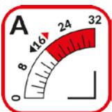
Der maximale Dauerstrom darf den Nennstrom nicht übersteigen (siehe Datenblatt).
