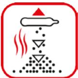
Die E-Bulb sollte grds. möglichst weit oben im Gehäuse platziert werden. Das Löschmedium NOVEC ist schwerer als Luft und sinkt somit automatisch zum Gehäuseboden. Darüber hinaus steigt bei einem Brand die warme Luft nach oben. Die E-Bulb sollte somit in durch den heißen Luftstrom entstehende Thermik platziert werden. Dadurch kann eine schnellere Auslösung erreicht werden.
