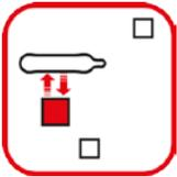
Zur Steigerung der Löscheffektivität hilft es, die möglichen Hotspots“ zu identifizieren, um die E-Bulb optimal platzieren zu können. Je dichter die E-Bulb am möglichen Brandherd platziert ist, desto besser. Jedoch ist sicherzustellen, dass im Falle eines Brandes die Konvektion der Luft die E-Bulb erreicht. Achtung ist insbesondere in „Ecken“ geboten.
