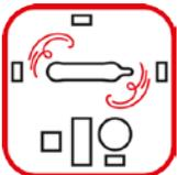
Eine möglichst freie Luftanströmung der E-Bulb sollte gewährleistet sein, d.h. wir empfehlen eine möglichst wenig umbaute und freistehende Einbaulage.
