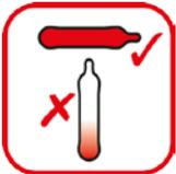
Zur Auslösung der E-Bulb bedarf es einer kompletten Durchwärmung der E-Bulb. Eine horizontale Einbaulage ist deshalb oft empfehlenswert.
