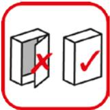
Im besten Fall ist das Gehäuse komplett verschlossen. Sollte auf Grunde von Lüftungsschlitzen oder Designanforderungen kein komplett abgeschlossener Raum zur Verfügung stehen gilt: Je geschlossener das elektronische Gehäuse desto besser und wahrscheinlicher ist es, den Brand löschen zu können.
